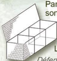
Parallélépipèdes rectangles d'une largeur de 1 m et d'une hauteur de 0.50 ou 1 m, les gabions boîtes sont disponibles avec plusieurs combinaisons mailles/fils (mailles types 60x80, 80x100 et 100x120 et fils de 2 à 3 mm, galvanisés très richement, revêtu de GalFan® ou encore de PVC ou polymère). D'une longueur de 1.50, 2, 3, 4 et 5 m, ils sont (à partir de 2 m) compartimentés tous les mètres par des cloisons appelées diaphragmes.
