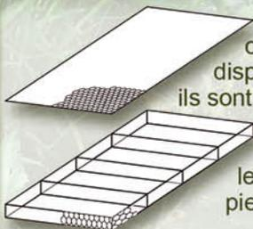
Parallélépipèdes rectangles de faible épaisseur et de grande surface (large de 2 ou 3 m et d'une épaisseur de 0.20, 0.25, 0.30 et 0.50 m), les gabions matelas sont disponibles avec plusieurs combinaisons mailles/fils. D'une longueur de 2, 3, 4, 5 et 6 m, ils sont compartimentés tous les mètres par des cloisons appelées diaphragmes.
