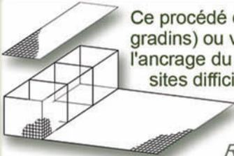
Ce procédé de remblais armés associe un parement en gabion (droit ou en gradins) ou végétalisable (incliné) à des nappes de renforts horizontales qui apportent l'ancrage du parement et le renforcement du massif. Mise en œuvre facile même dans des sites difficiles d'accès. Les éléments d'une largeur de 2, 3 ou 4 m ont une longueur variable, fonction de la hauteur de l'ouvrage, des caractéristiques des sols et des surcharges.
